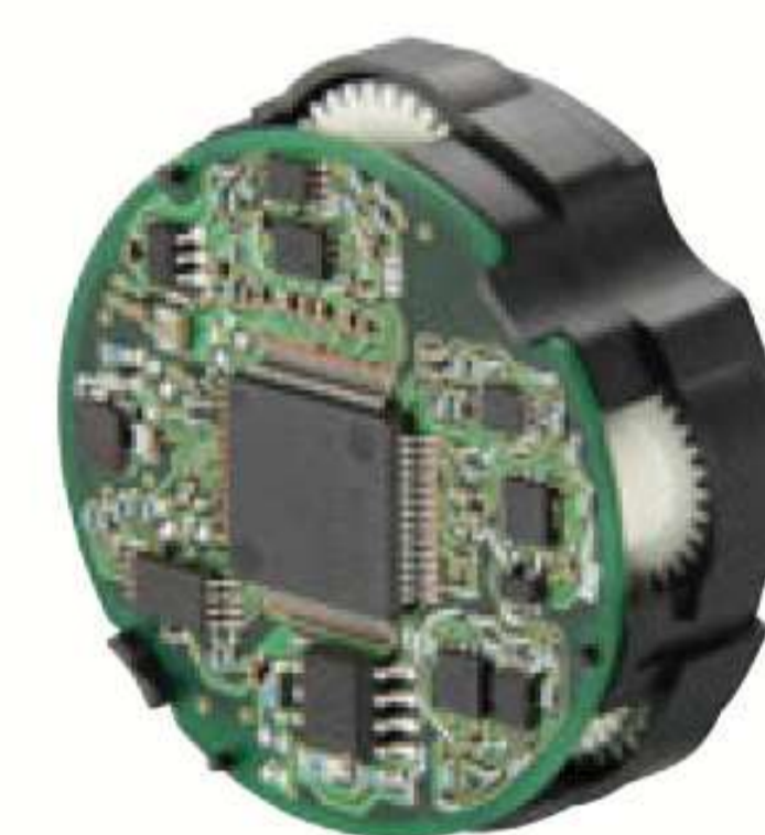
เซ็นเซอร์กลไกแบบสัมผัส <ABZO Sensor>
